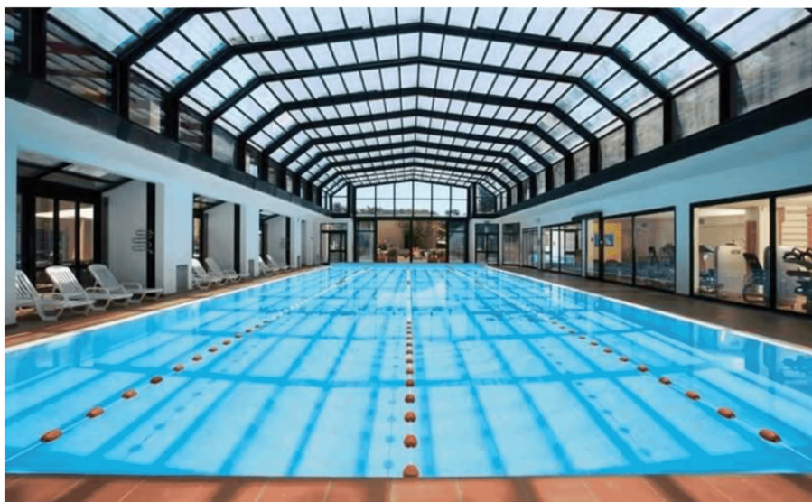
Рисунок 16 – Пример устройства бассейна с отделением его противопожарными светопрозрачными перегородками от тренажерного зала
