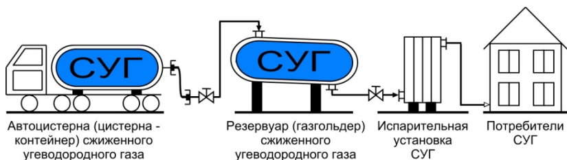
Рис. 1.1. Принципиальная технологическая схема автономной системы газоснабжения СУГ
