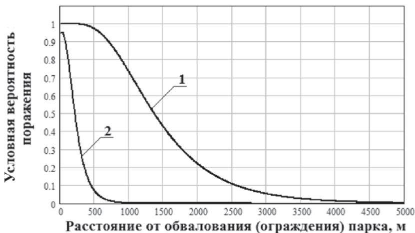
**Рис. 3.2.11. Зависимости условных вероятностей поражения человека волной давления от расстояния до обвалования (ограждения) парка:**
