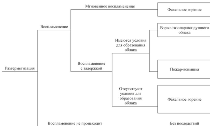
**Рис. ПЗ.3. Типовое дерево событий при возникновении и развитии пожароопасной ситуации, связанной с разгерметизацией единицы технологического оборудования (1-го аппарата) и истечением ГГ или паров ЛВЖ**
