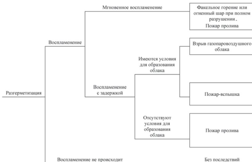
**Рис. ПЗ.2. Типовое дерево событий при возникновении и развитии пожароопасной ситуации, связанной с разгерметизацией единицы технологического оборудования (1-го аппарата) и истечением жидкой фазы или двухфазной смеси СУГ или ЛВЖ**
