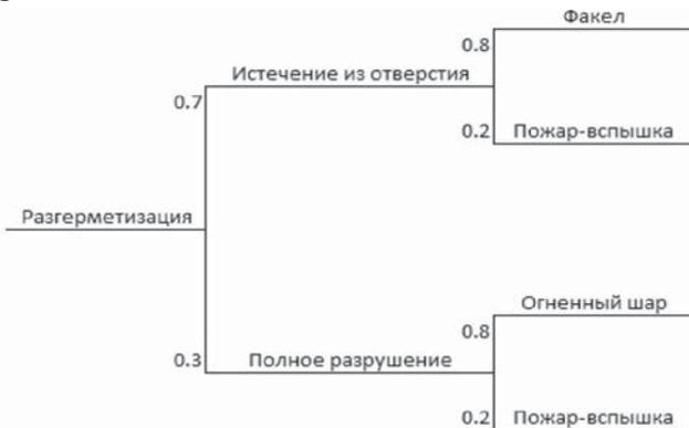
**Рис. 3.8.1. Дерево событий при возникновении и развитии пожароопасной ситуации, связанной с разгерметизацией автомобильной цистерны с СУГ**
