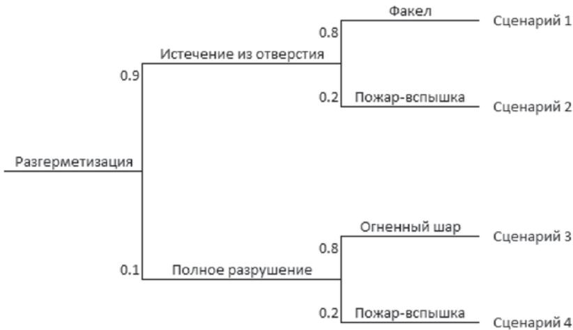
**Рис. 3.9.1. Дерево событий при возникновении и развитии пожароопасной ситуации, связанной с разгерметизацией железнодорожного вагона-цистерны с СУГ**
