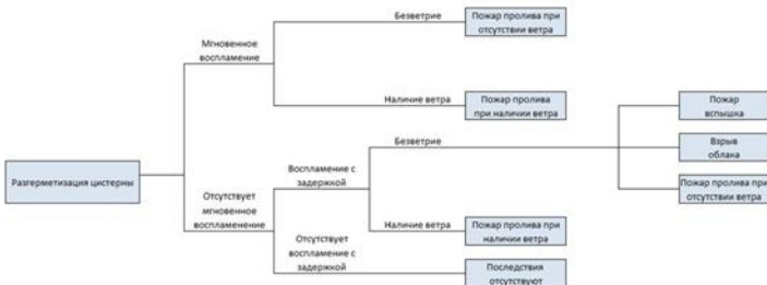
Рис. 3.7.1. Дерево событий при возникновении и развитии пожароопасной ситуации, связанной с разгерметизацией железнодорожной вагона- цистерны с ЛВЖ
