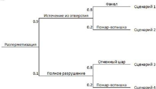
Рис. 3.9.1. Дерево событий при возникновении и развитии пожароопасной ситуации, связанной с разгерметизацией железнодорожной вагона-цистерны с СУГ
