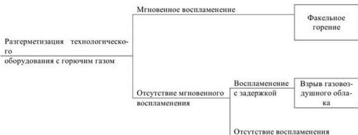
Рис. 3.6.2. Дерево событий при возникновении и развитии пожароопасных ситуаций и пожаров, связанных с разгерметизацией технологического оборудования с горючими газами, а также подводящих/отводящих к оборудованию трубопроводов в помещении
