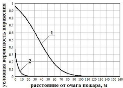
Рис. 3.2.10. Зависимости условных вероятностей поражения человека тепловым излучением от расстояния до очага пожара
