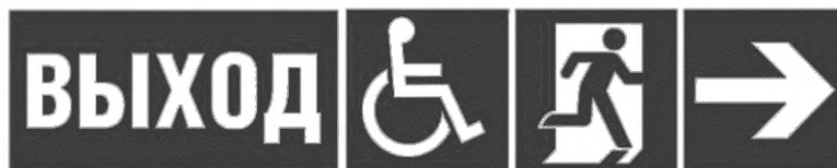
Рисунок 5 — Пример комбинации эвакуационных знаков
