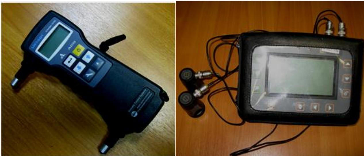
Рисунок 13. Ультразвуковые дефектоскопы с зафиксированным (а) и изменяемым (б) расстоянием между датчиками
