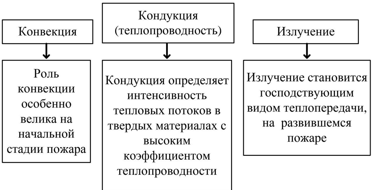
Рисунок 8 Виды передачи тепла на пожаре
