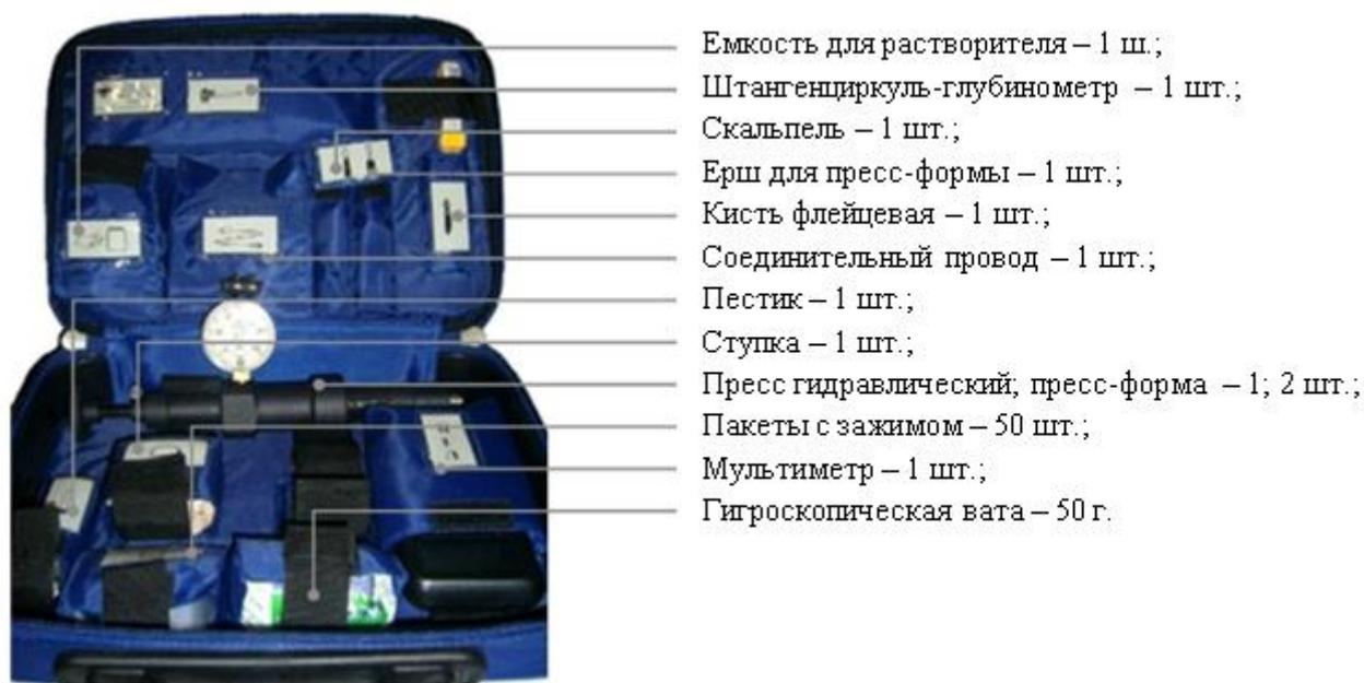
Рисунок 47. Комплект оборудования АКО1-01-ЭП для работы на месте пожара
