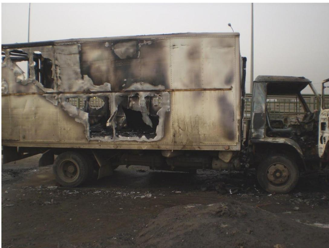
Рисунок 23. Визуальными признаками горения металлов является разрушение конструкций в зоне горения. От выгоревшей детали часто остается ажурный скелет.
