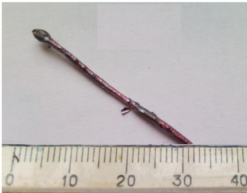
Рисунок 35. Оплавление на медном проводнике
